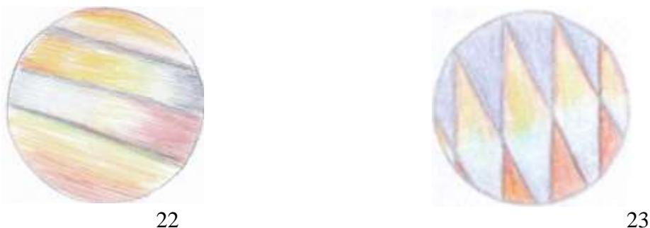
Comparando el dibujo 22 con el dibujo 18, podemos ver que los colores de ambas interferencias se mezclan. En el dibujo 23, se forman unas bandas de interferencia verticales y anchas, que son atravesadas por bandas de interferencia que golpean oblicuamente desde arriba a la izquierda hasta abajo a la derecha. Una vez más, ambas subestructuras se "mezclan" entre
