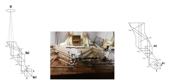
Comme nous travaillons avec deux séparateurs de faisceaux qui doivent se trouver dans le même plan, cette configuration exige encore plus de précision.
